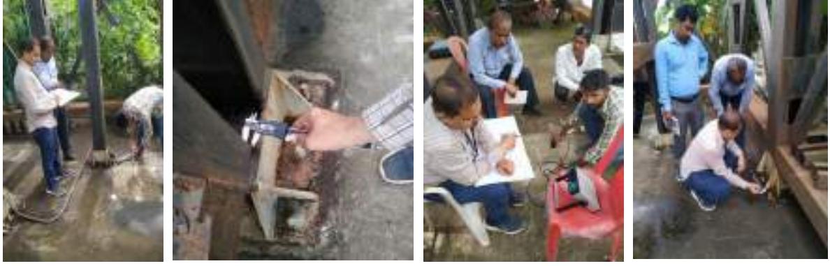
पुरी, ओडिशा में स्टील वाटर टैंक का एसएआर (एनडीटी) परीक्षण
