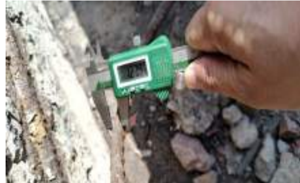
किसी भवन स्थल पर आर.सी.सी. सदस्य के विद्यमान रीबार व्यास का मापन
