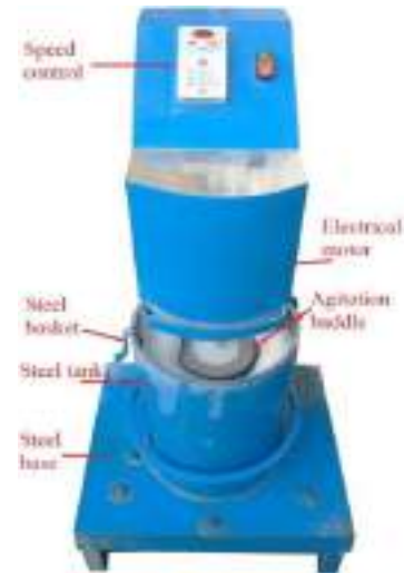
चित्र 2. एएसटीएम सी1138 घर्षण परीक्षण मशीन
