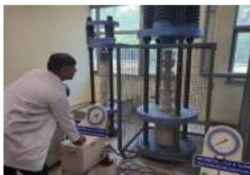
कठोर कंक्रीट नमूना- क्रीप अवलोकन
