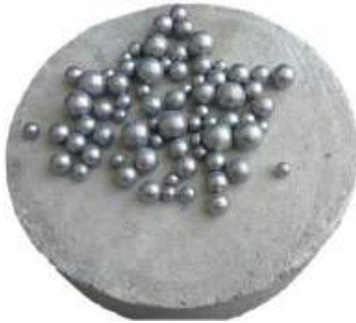
चित्र 1. परीक्षण डिस्क नमूना और स्टील गेंदें।
