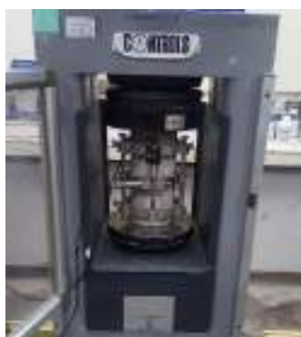
कंक्रीट नमूने के प्रत्यास्थता मापांक और पॉइसन अनुपात के मूल्यांकन के लिए परीक्षण सेट अप
