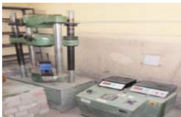
एनसीबी अहमदाबाद इकाई में सुदृढीकरण परीक्षण सुविधा के लिए यूनिवर्सल परीक्षण मशीन
