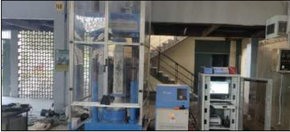
प्रगति के तहत उच्च शक्ति कंक्रीट प्रबलित स्तंभों का परीक्षण
