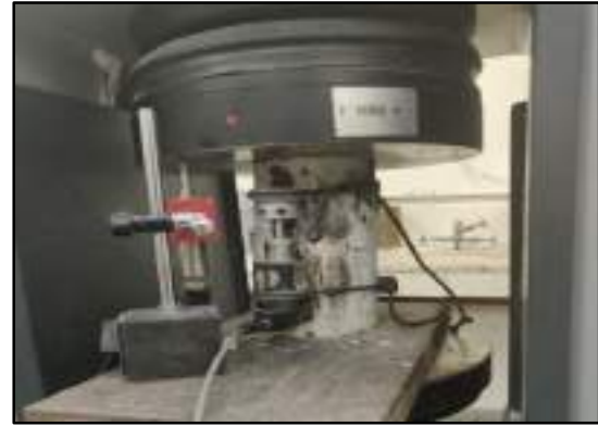
600० सी पर कंक्रीट सिलेंडर की लोच के मापांक के लिए परीक्षण सेटअप
