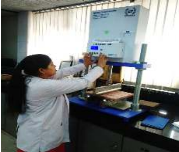
सीमेंट कंक्रीट टाइल का फ्लेक्सुरल परीक्षण
