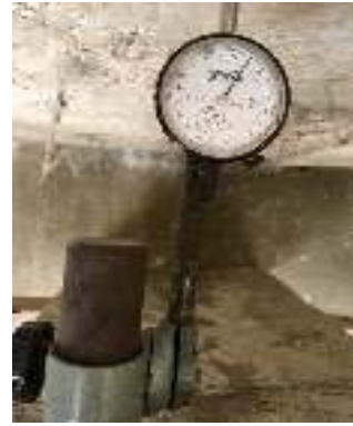
प्रायोजित परियोजना स्थल पर चल रहे आईआरसी एसपी-37 के अनुसार रेलवे ओवर ब्रिज के भार परीक्षण द्वारा भार वहन क्षमता का निर्धारण
