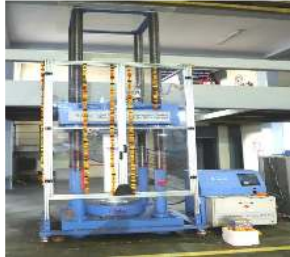
प्रबलित कॉलम के व्यवहार की जांच के लिए कॉलम परीक्षण मशीन
