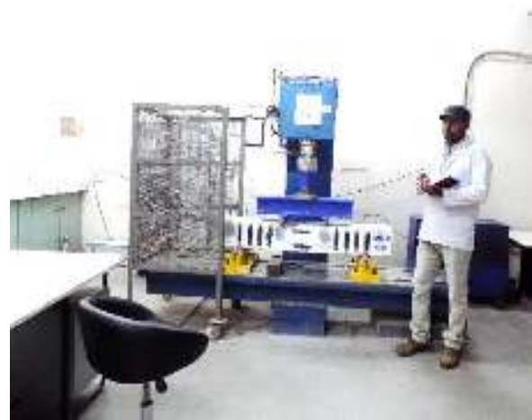
फ्लेक्सुरल परीक्षण मशीन- प्रबलित बीम के परीक्षण के लिए 500kN
