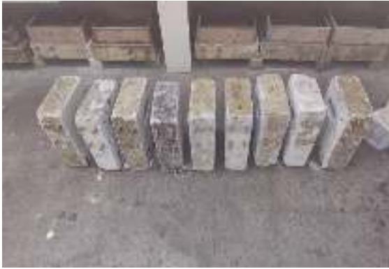
कार्बोनेशन प्रेरित जंग के तहत प्रयोगशाला अध्ययन के संबंध में एनोड की स्थापना के लिए चयनित कंक्रीट स्लैब नमूने
