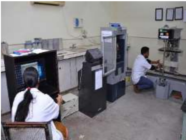
कंक्रीट की फ्लेक्सुरल कठोरता के निर्धारण के लिए स्ट्रेन नियंत्रित फ्लेक्सुरल टेस्टिंग मशीन
