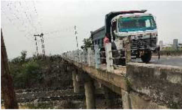
प्रायोजित परियोजना स्थल पर चल रहे आईआरसी एसपी-37 के अनुसार रेलवे ओवर ब्रिज के भार परीक्षण द्वारा भार वहन क्षमता का निर्धारण
